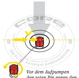
Vor dem Aufpumpen den roten Pin gegen den Uhrzeigersinn drehen
