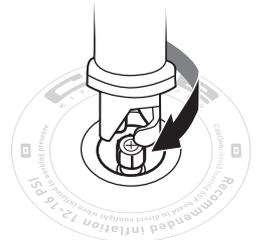
5. Pumpe dein iSUP mit der mitgelieferten Handpumpe auf 12–16 psi auf. Optional kann auch eine geeignete elektrische Pumpe benutzt werden.
