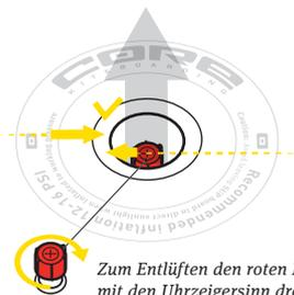
Zum Entlüften den roten Pin mit den Uhrzeigersinn drehen
